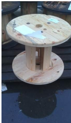
En kärnvirkesbit borta. Trumman klassas som 80% om K11 eller större annars som 60%
